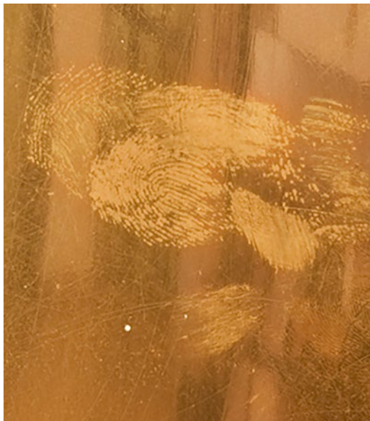
Abb. 4: Detailansicht der Oberfläche: Massenhafte Berührungen mit bloßen Händen haben korrodierte Fingerabdrücke auf der Skulptur hinterlassen. Fotos: Christoph Wenzel
