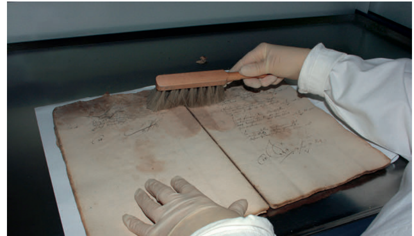
Dekontamination bei mikrobiellem Befall: Trockenreinigung gemäß TRBA 240. Foto: Landesarchiv Baden-Württemberg
